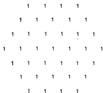
Obr. 3. Geometrická prezentace hexagonálního průměrujícího filtru
